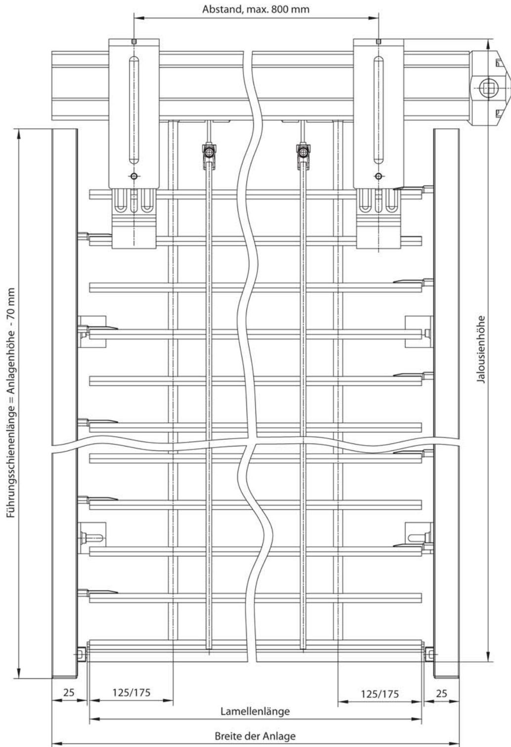
Querschnitt, Abmessungen in [mm]
