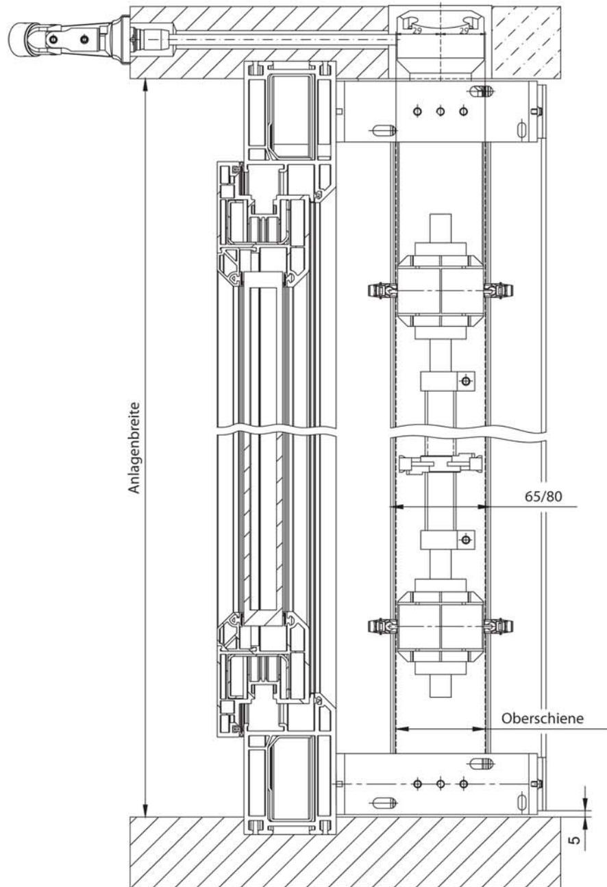
Querschnitt, Abmessungen in [mm]
