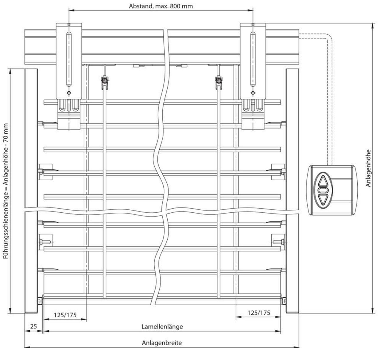
Frontansicht ohne Blende, Abmessungen in [mm]
