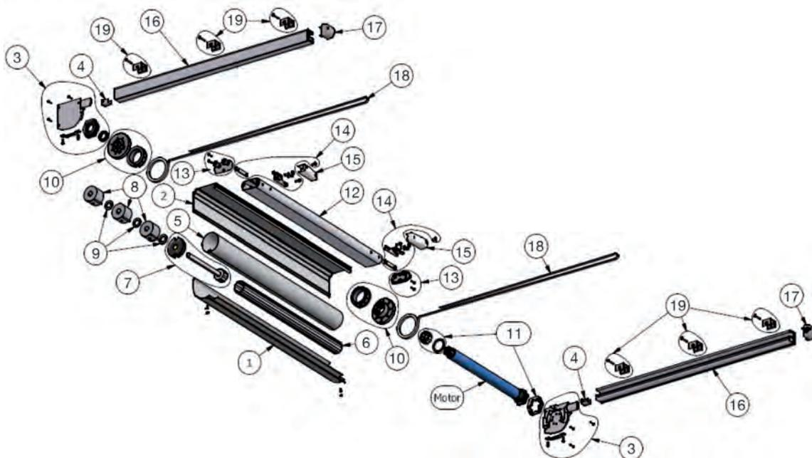
1. Vorderteil - 2. Rückenteil - 3. Seitenteil - 4. Bandumlenkung - 5. Tuchwelle  $\varnothing$  85 mm - 6. Motorwelle - 7. Reduktionseinheit - 8. Triebfeder - 9. Scheibe Triebfeder - 10. Bandscheibe - 11. Zubehör Motor - 12. Fallprofil - 13. Endkappe Fallprofil - 14. Bandspanner - 15. Abdeckung Bandspanner - 16. Führungsschiene - 17. Endkappe Führungsschiene - 18. Zugband - 19. Klippkonsole
