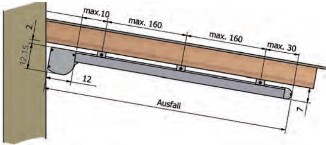
**i** Das Ausfallprofil kann technisch bedingt nur bis ca. 6,6 cm vor Schienenende ausgefahren werden.
