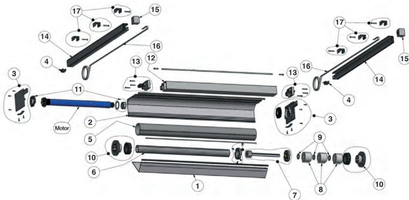
1. Vorderteil - 2. Rückenteil - 3. Seitenteil - 4. Bandumlenkung - 5. Tuchwelle  $\varnothing$  85 mm - 6. Motorwelle - 7. Reduktionseinheit - 8. Triebfeder - 9. Scheibe Triebfeder - 10. Bandscheibe - 11. Zubehör Motor - 12. Fallprofil - 13. Endkappe Fallprofil - 14. Führungsschiene - 15. Endkappe Führungsschiene - 16. Zugband - 17. Klippkonsole
