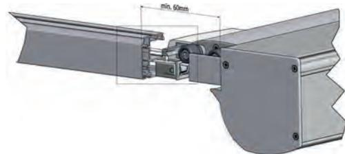
**!** Beim Zusammenbau der Anlage unter dem Sparren wird ein Einbauspielraum von ca. 10 cm zum Aufstecken des Gehäuses sowie der Schienenendkappe in die Führungsschienen benötigt.
