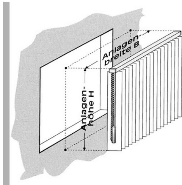
Bestellbreite = Tragen Sie bitte das fertige Breitenmaß ein, also die Breite der Oberschiene, an dem die Lamellen eingehängt werden.
